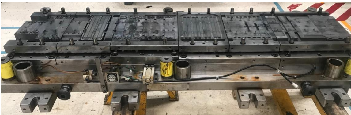
Imagen 8. Parte superior de un troquel para mantenimiento preventivo con 4 secciones.
