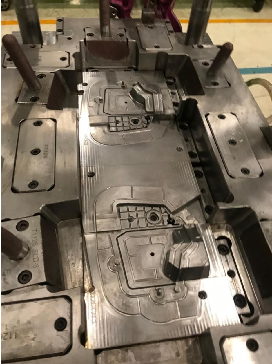
Imagen 11. Lado cavidad de un molde después de un preventivo.
